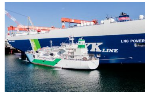
LNG燃料船へのバンカリング状況
