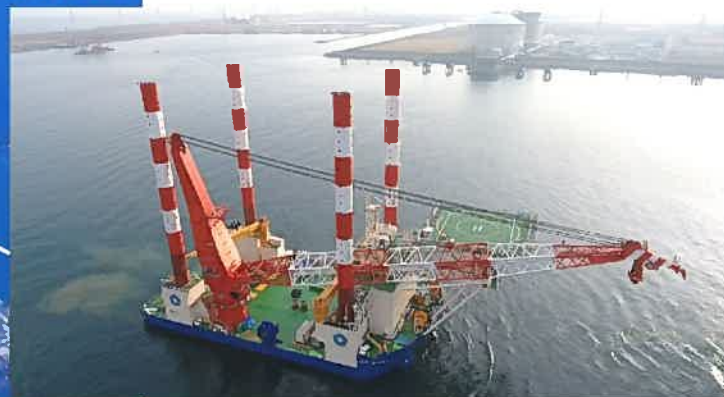
北九州港（響灘）に初入港したSEP型多目的起重機船CP-8001
