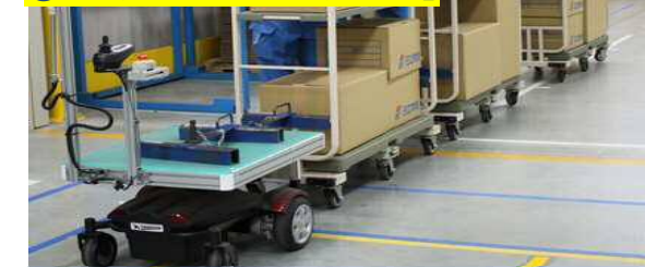
【機能】仕分けエリア～荷揃えエリアへ無人搬送、作業負荷軽減
