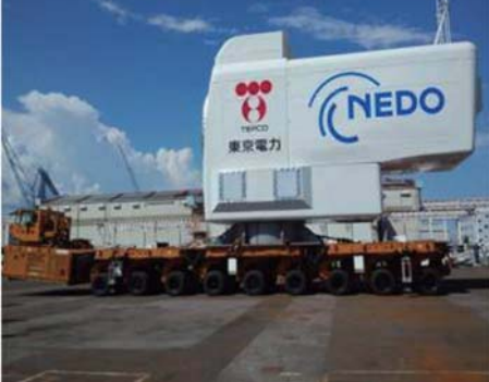
一体組されたナセル (MWT92洋上実証機)
